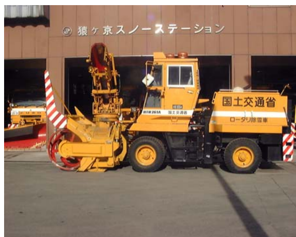
関東地方整備局から支援されるロータリ除雪車
