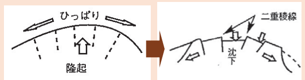
山体の外側へのずり落ちと稜線部での沈下による二重山稜の形成
