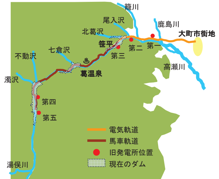
図 5.6 高瀬川の電源開発当時の発電所の位置、軌道等のルート概要と現在のダムとの関係
