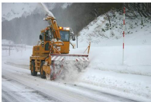
拡幅除雪の状況
