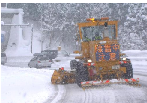
路面整正の状況
