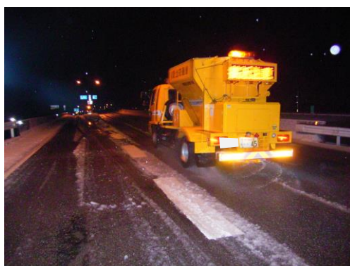
凍結防止剤散布の状況
