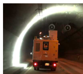
▲トンネルの変状写真を撮影する技術
