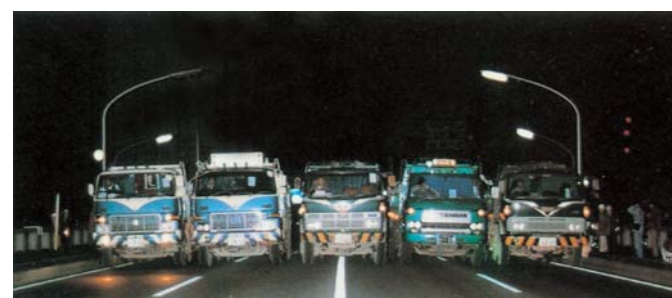
▲萬代橋で実施された載荷試験
