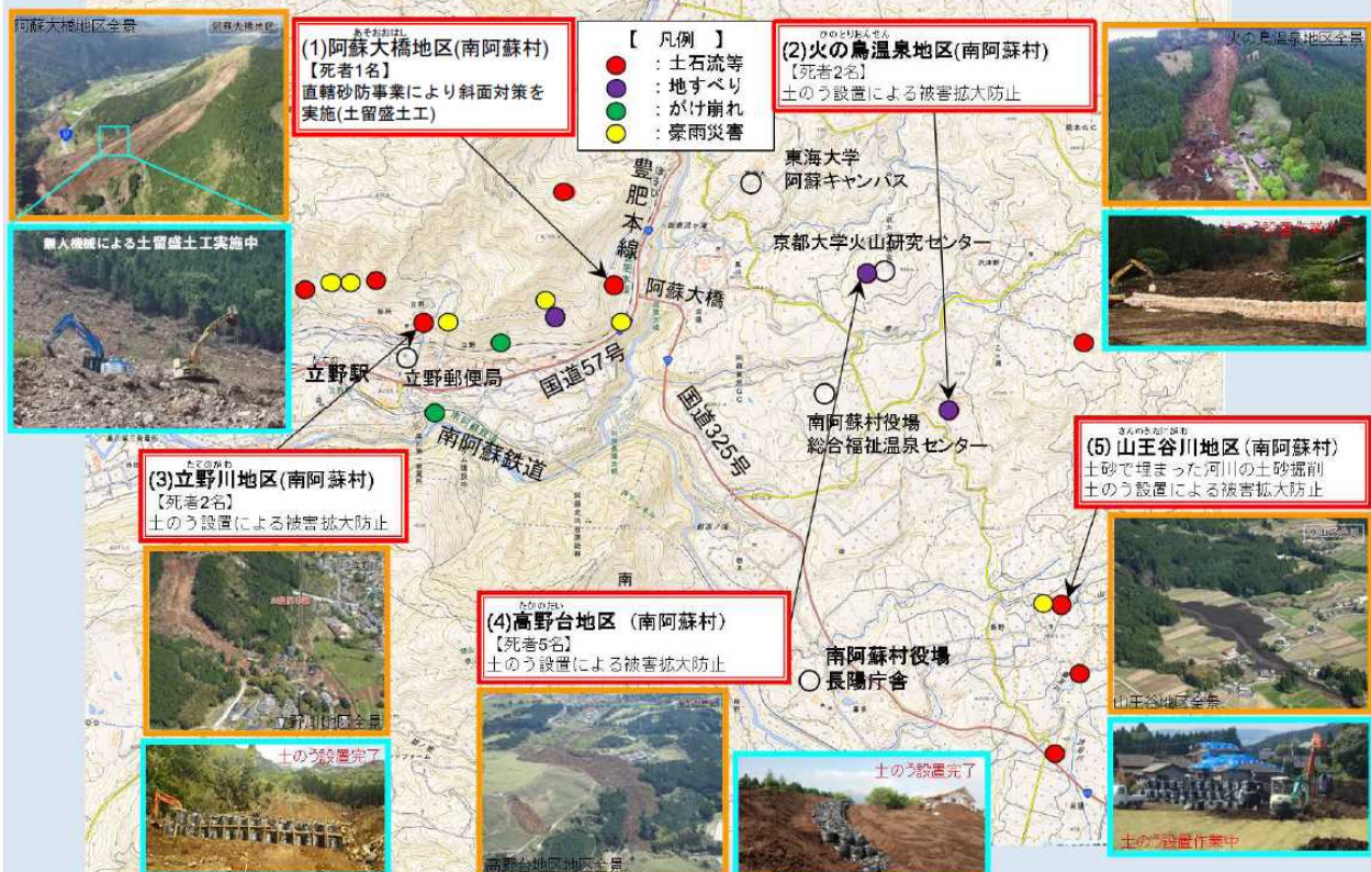
特に被害が著しい南阿蘇村周辺の主な土砂災害と応急対策状況
