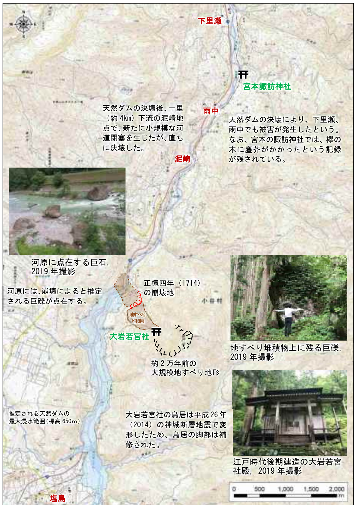
図 2.11 岩戸山付近の大規模地すべり（崩壊）と天然ダムの湛水範囲（地理院地図に加筆）
