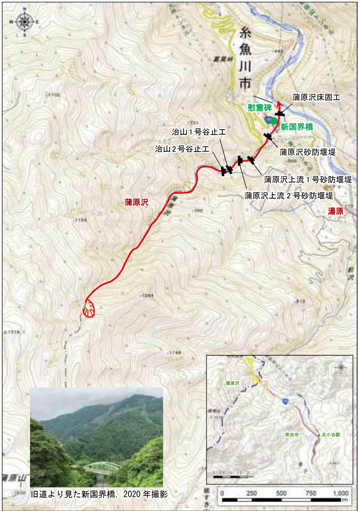
図 2.46 蒲原沢の土石流の災害状況図（地理院地図に加筆）
