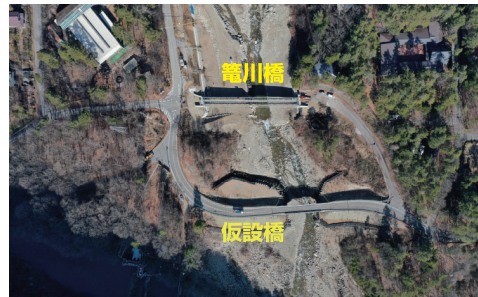
箆川橋 日向山床固工群の整備に伴う河道拡幅により、箆川橋の架替を行う為の箆川橋仮設橋を設置するとともに県道を築造しています。
