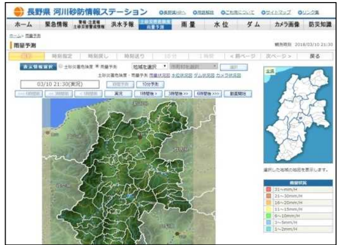
10分ごと1時間先までの雨量予測と、1時間ごと6時間先までの雨量予測が閲覧できます。
