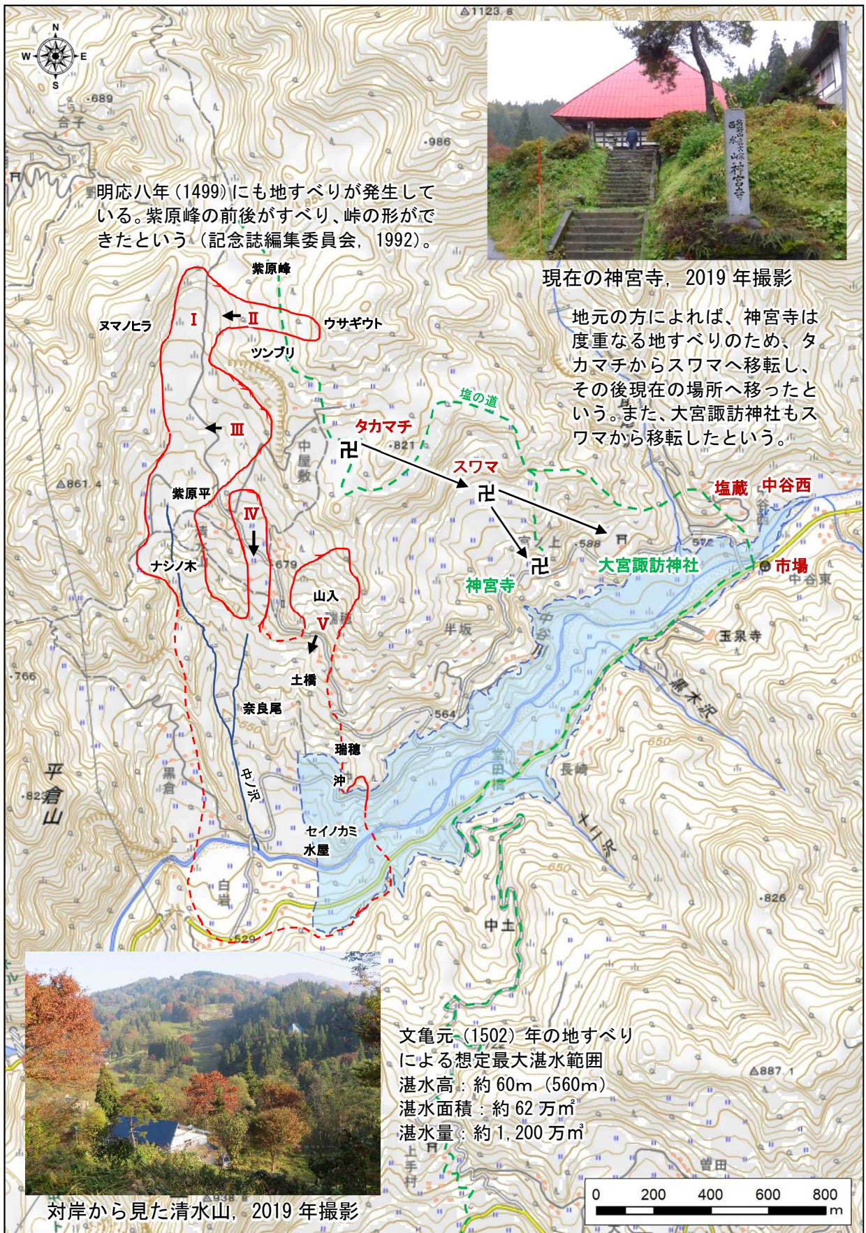
図 2.4 清水山地すべりブロック区分図と文亀元年(1502)の天然ダムの想定湛水域(地理院地図に加筆)
