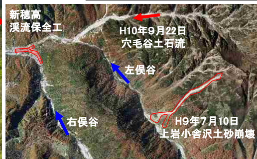
上流域の荒廃状況と土石流発生履歴
