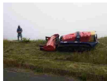
大型遠隔式除草機械による除草
