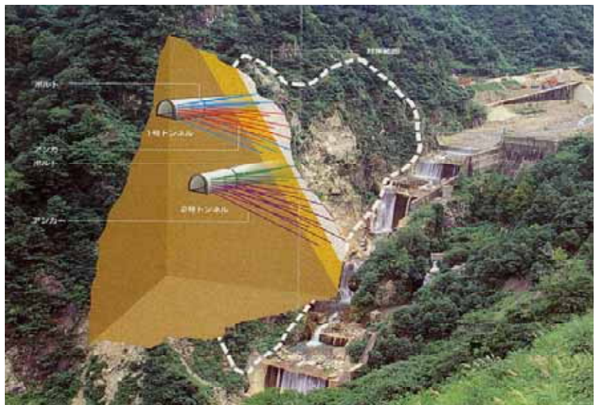
白岩砂防えん堤右岸部斜面岩盤補強対策の概要
