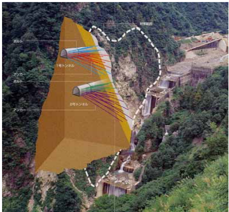
白岩砂防えん堤右岸部斜面岩盤補強対策の概要
