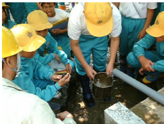
横ボーリング排水量測定状況
