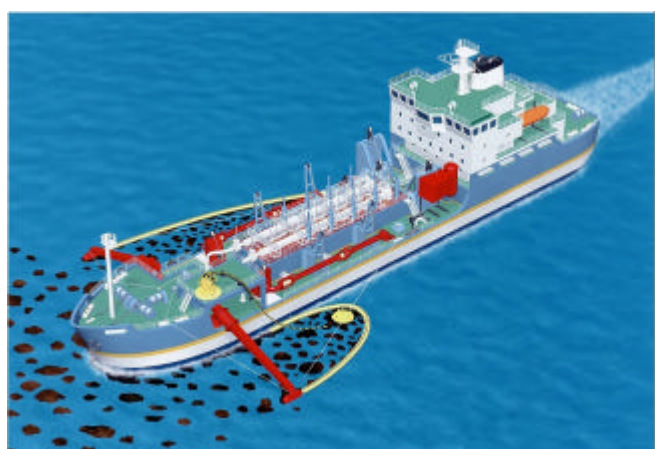
流出油の回収作業を行う大型浚渫兼油回収船「白山」のイメージパース
