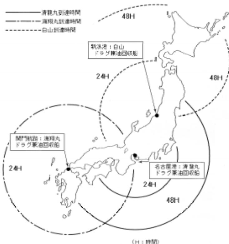
図に示す円弧は、海上静穏時に各船最大速力での到達範囲を示す。
