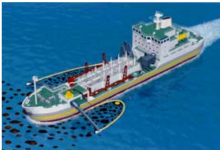
油流出の回収作業を行うドラッグ浚渫兼油回収船イメージ
