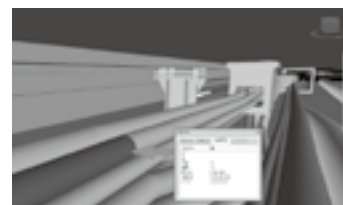
CIM技術の適用 3次元モデル上での地下埋設物の 確認▶P.9
