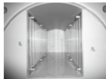
音響実験に供したレゾウォールサイレンサーの例 ▶P.57
