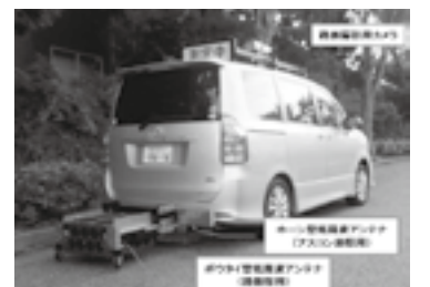
構造キャッチャー測定車両の全景▶P.33
