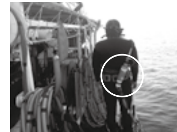
潜水士へのトランスポンダ設置状況 ▶P.15
