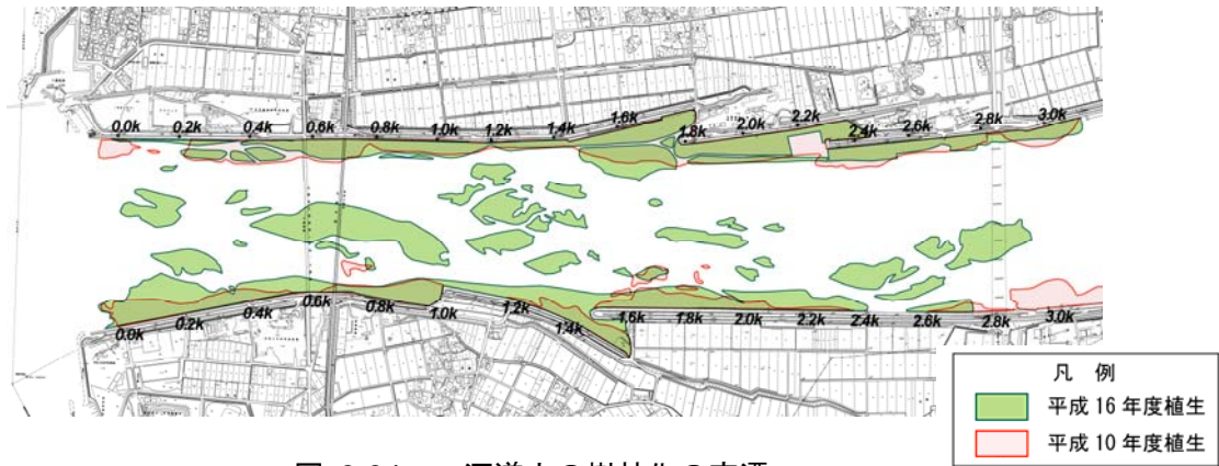
図 3-34 河道内の樹林化の変遷
