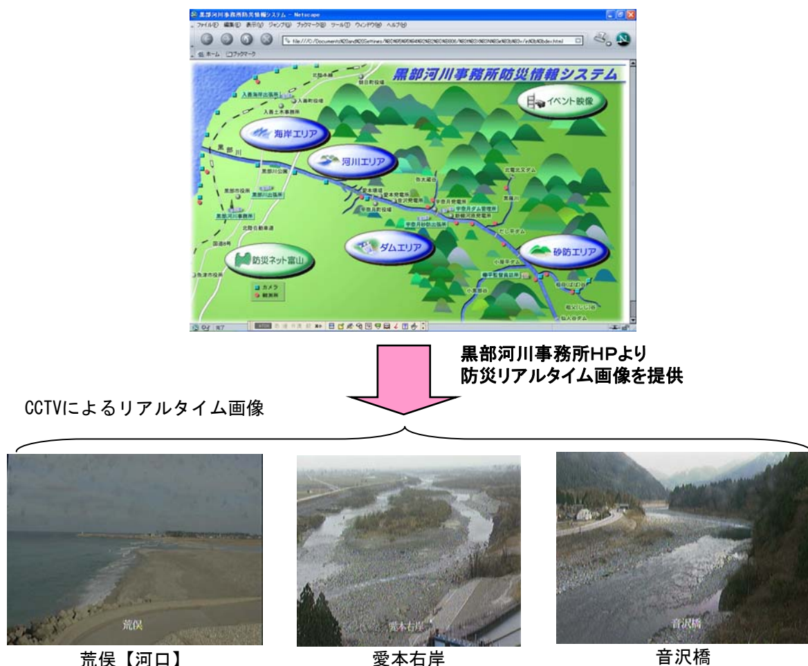
図 3-37 CCTV カメラによる遠隔監視
