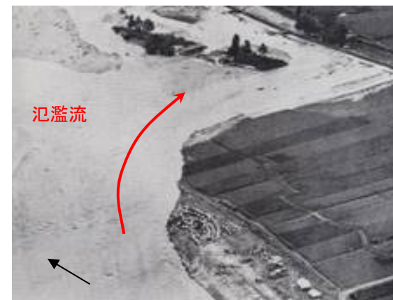
洪水流による破堤状況 (昭和44年8月洪水)
