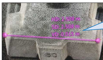
写真3. 点群データから「幅」等の2点間計測が可能
