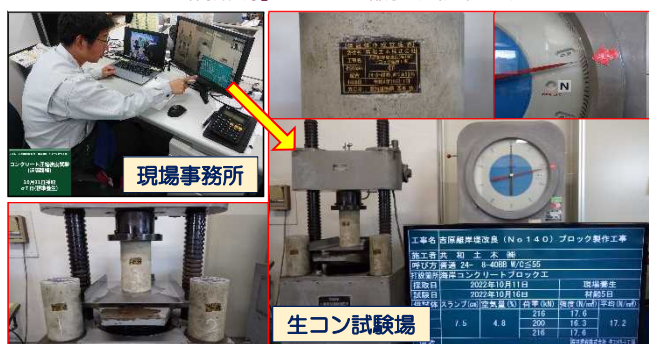
写真6. 「遠隔臨場」による圧縮強度試験の実施状況
