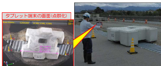
写真1. タブレット端末による3次元計測（点群化）
