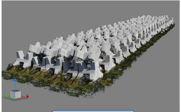
UAV撮影による点群データ
