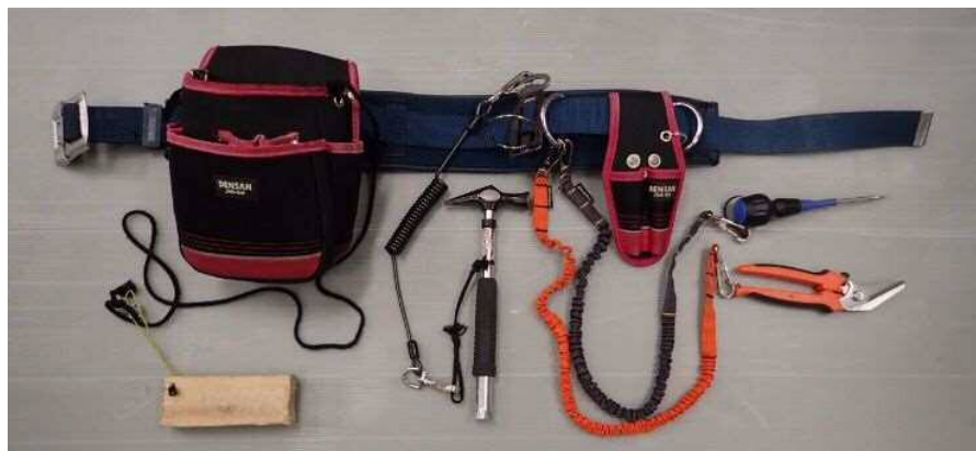
【写真4 落下防止ワイヤー取付状況（展開時 3本取付）】
