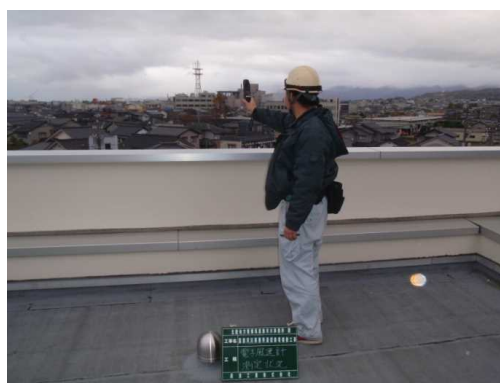
【 写真-6 仮設足場吹き流し取付状況 】 【 写真-7 デジタル風速計測定状況 】
