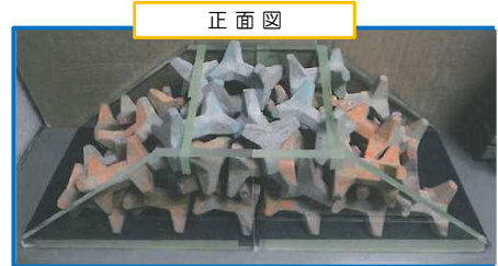
【立方体容器による空隙率算定】
