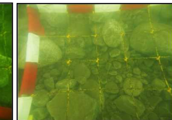
減勢池内に20cm内外の土砂が堆積 (H27減勢池調査)
