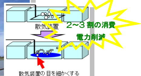
省エネルギー化の事例 散気装置の消費電力削減例
