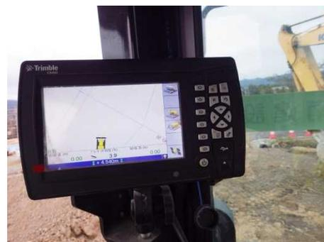
施工機械内の情報化施工機器
