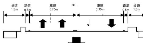
● 自歩道計画横断面図【標準部】(総幅員 約22m)
