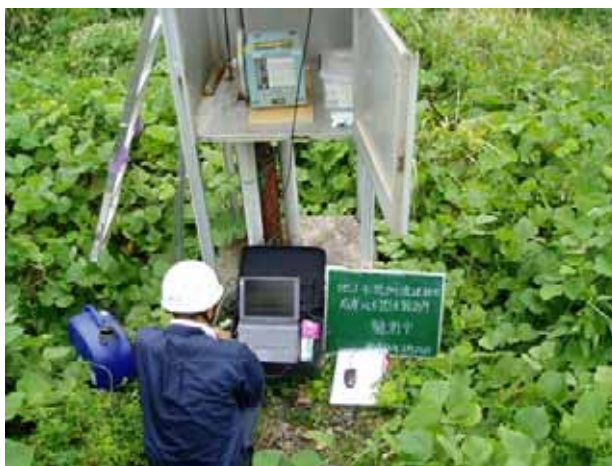
図 82 地下水水位・流向観測
