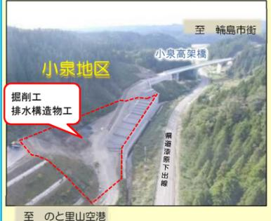
本工事は、三井町小泉地区において、主に盛土工・排水構造物工を行い、三井町洲衛地区では掘削工、排水構造物工を主に施工いたします。当現場では、ICT(情報通信技術)建設機械を使用して生産性の向上と、安全の向上を図り、【安全第一】で工事の完成を目指します。また、土砂運搬時には、県道漆原下出線から工事車両が出入りするため、工事期間中は皆様にはご迷惑をお掛けしますがご理解とご協力の程よろしくお願い致します。
