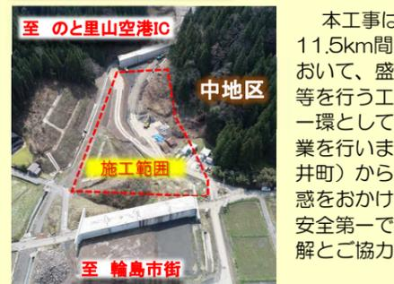
本工事は、能越自動車道・輪島道路11.5km間の内、石川県輪島市三井町中地区において、盛土工、地盤改良工、排水構造物工等を行う工事です。当現場では生産性向上の一環として、ICT技術を導入した重機により作業を行います。工事期間中は、県道37号(三井町)から工事の出入りなどで皆様にはご迷惑をおかけすることもあるかと思いますが、安全第一で施工を行って参りますので、ご理解とご協力のほどよろしくお願いいたします。
