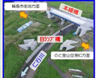
本工事は仁行川に架かる三井IC 橋(橋長L=33.6m)の工事で、鋼 製箱桁橋の製作及び架設、床版、 壁高欄を施工します。
