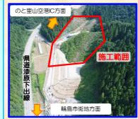
本工事は、小泉地区において本 線部分の盛土・切土工事とそれに 伴う土質改良工を主に行います。 また、 当工事では、ICT建機による 情報化施工(GNSSを利用したプル ドーザーの排土板の自動制御等) を行う予定をしております。
