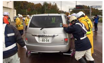
タイヤ付きジャッキを用いた車両移動
