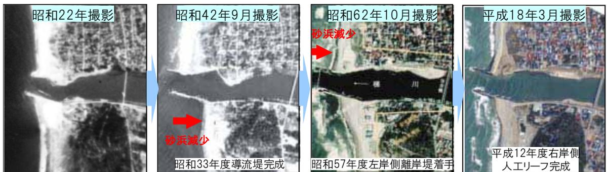
図 5-1 河口部平面形状の変化
