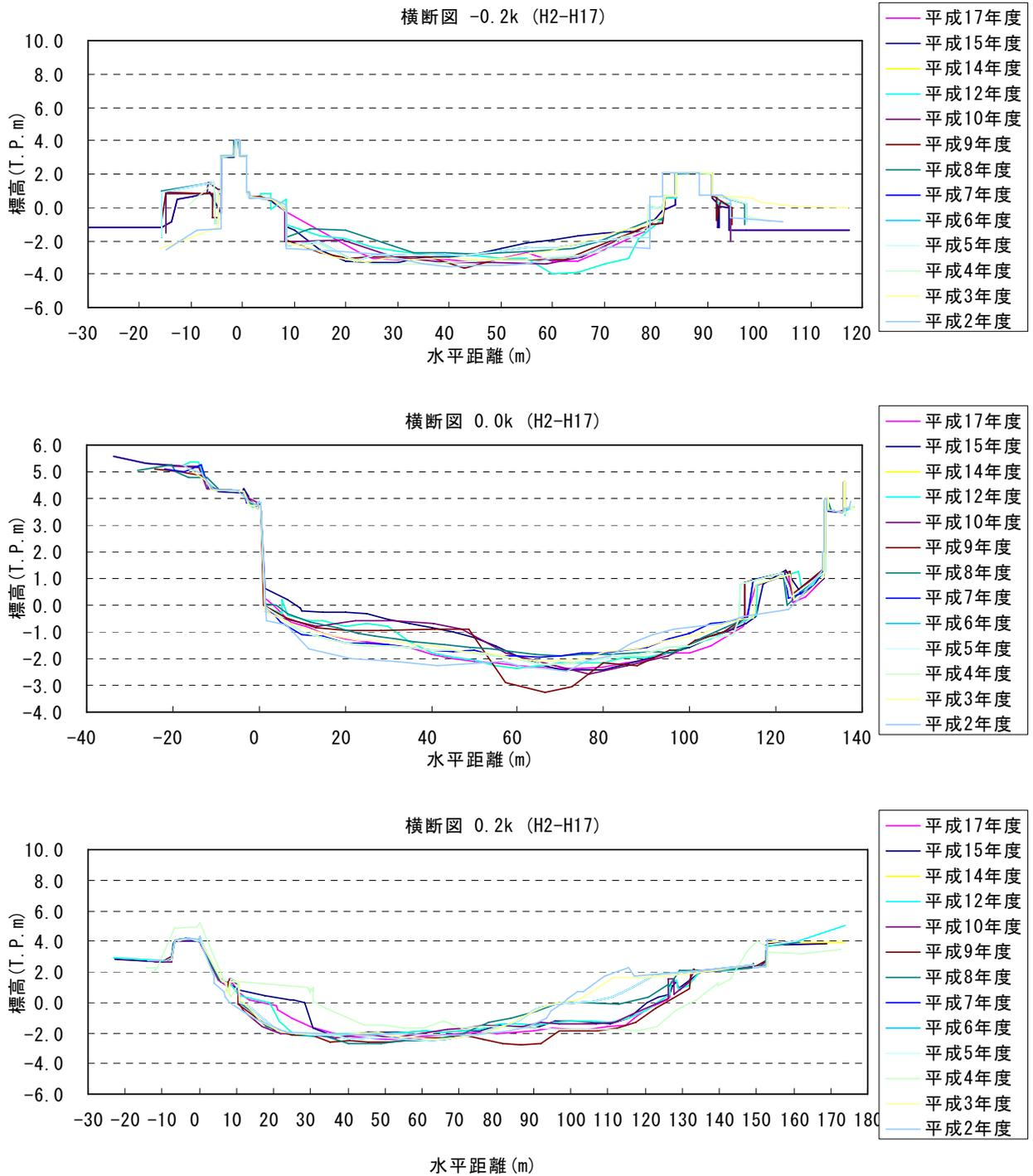
図 5-2 河口部横断面形状の変化
