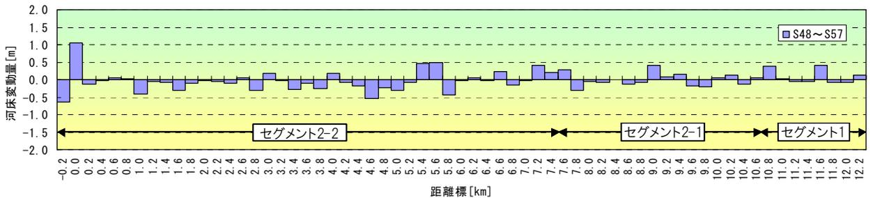
図 2-1 (1) 低水路内河床変動量経年変化図 (S48~S57)
