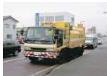
路面清掃車による清掃
