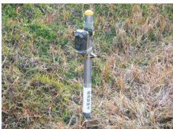
原因特定のための赤外線センサーカメラの設置
