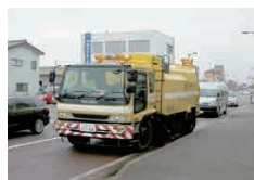
路面清掃車による清掃
