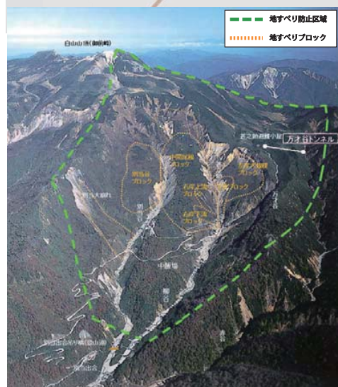
地すべり対策として集水ボーリング、排水トンネル工事等を促進します
