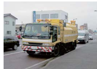
路面清掃車による清掃
