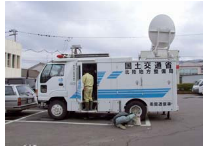
被災現場の情報収集に欠かせない衛星通信車
