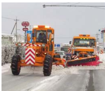
路面の積雪を排除する除雪グレーダ・除雪トラック
