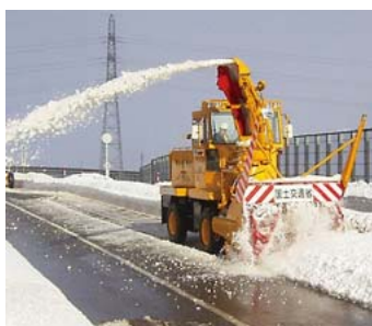
道路の幅を確保するロータリ除雪車
