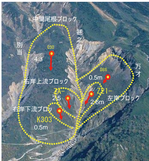
白山南西部の手取川上流基之助谷地すべりの全景 赤矢印で示した方向に、地すべりブロックが移動しています
