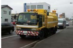
路面清掃車による清掃
