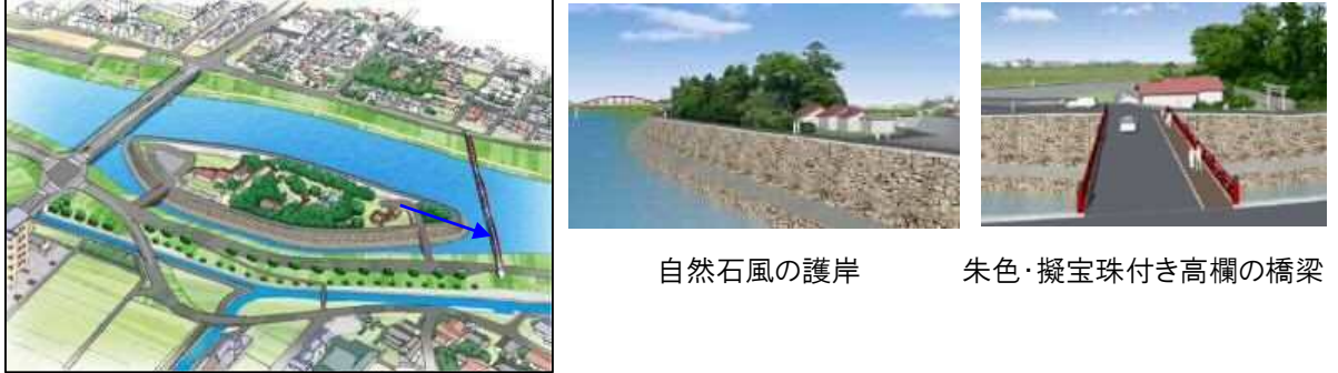
図 5.5 景観と調和した河川整備（小松天満宮と調和した分水路整備）
