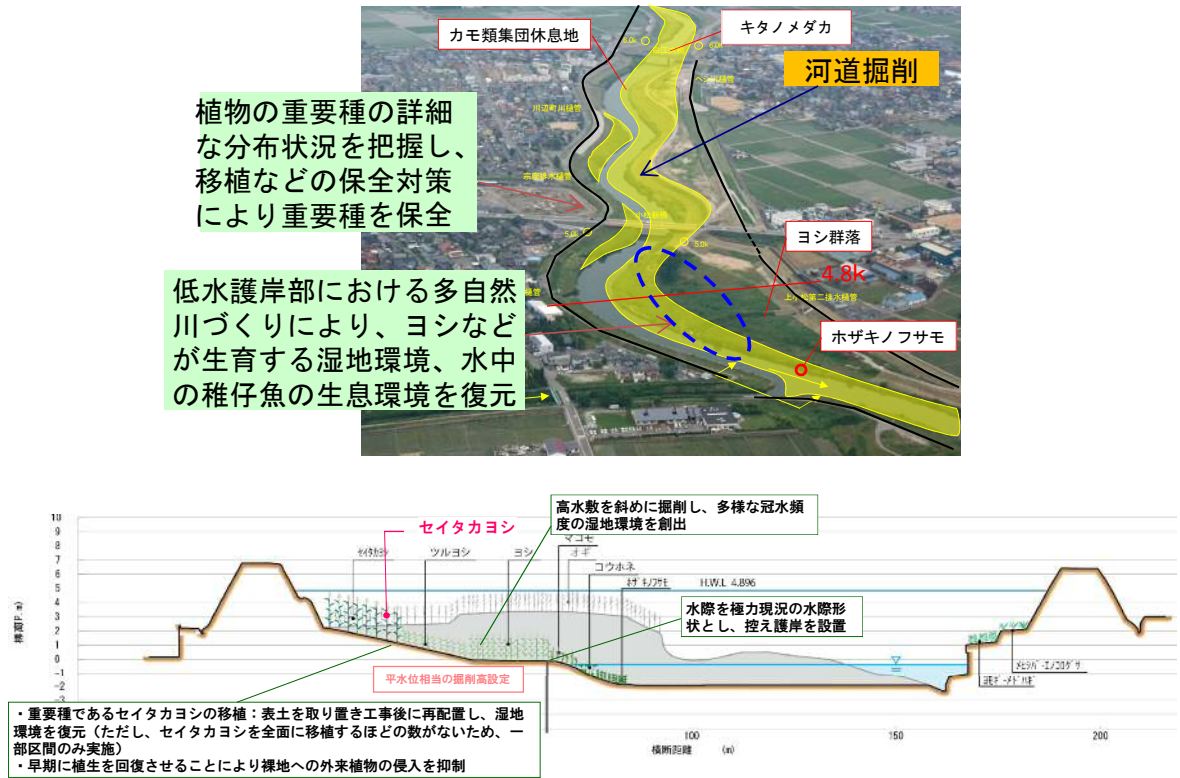
図 5.3 鍋谷川合流点下流部の整備断面イメージ図（4.8k 付近）
