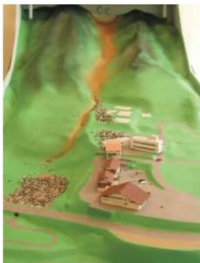
科学館周辺の白山まるごと体験村と、土石流危険渓流である風嵐裏谷、平成15年に施工された風嵐裏谷砂防堰堤を模型化し、実際に土砂と水を流して土石流発生の様子を観察することができます。模型は堰堤のある状態と無い状態のものがあり、両者を比較することでよりわかりやすく土砂災害について学ぶことができます。
