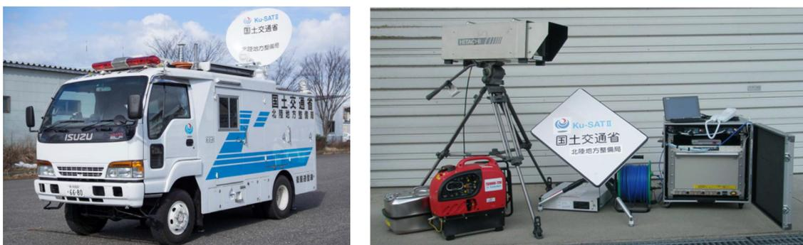
図 3.9 衛星系無線通信システムの例
