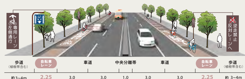
▼ B区間：中央分離帯を縮小し4車線を確保しつつ自転車レーンを設置
