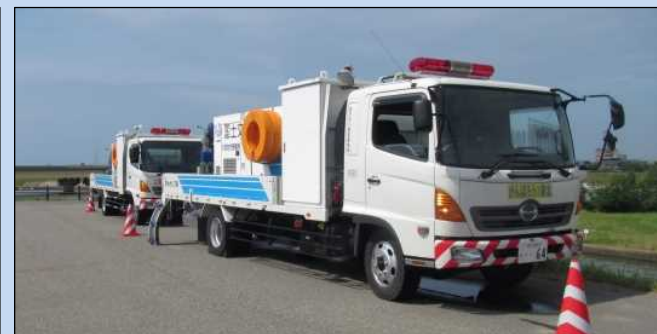
使用した 排水ポンプ車
