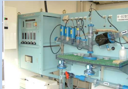
水質の自動観測機器 (手取川・白山水質自動観測所)
