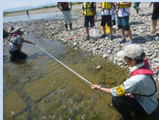
流速の測定（手取川）
