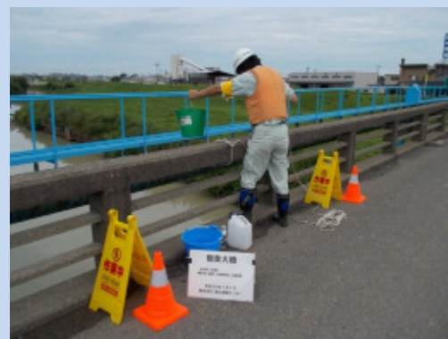
水質調査試料採水作業（梯川）
