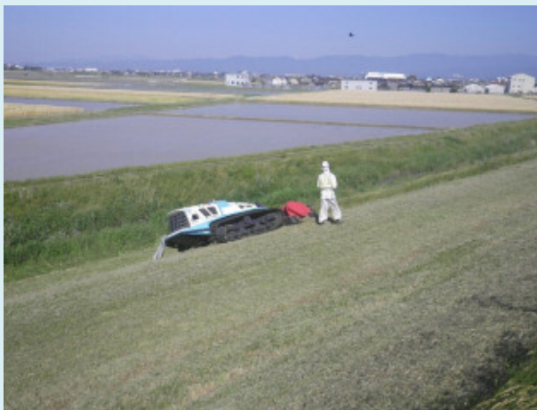
大型遠隔自走式機による除草作業（手取川）
