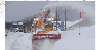
写真3-3 拡幅除雪の状況 (ロータリー除雪車)
