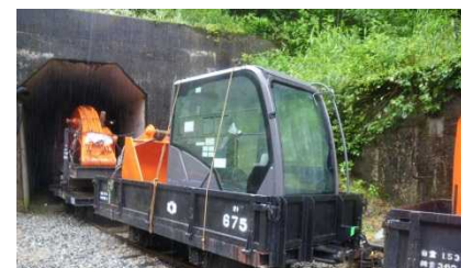
唯一の輸送手段である黒部峡谷鉄道による機材・資材等の分解輸送
