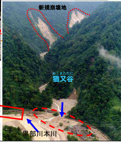
猫又谷で発生した新規崩壊と本川合流部付近の土砂流出被災状況
