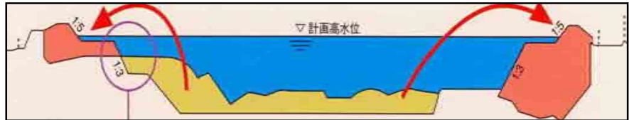
本川下流部 浚渫(流下能力の確保)
